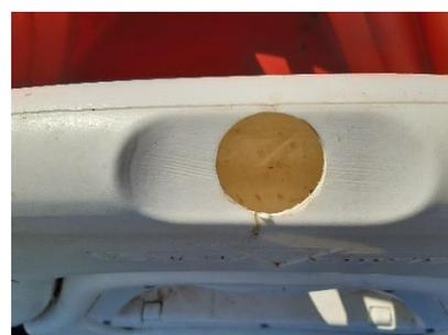
Photo 9 : Bornes sans bouchon et remplies d'eau
